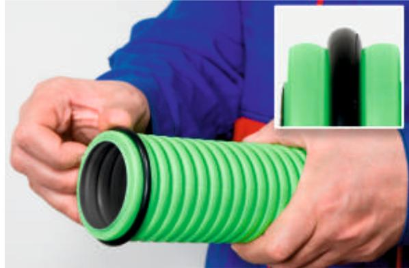
2) In die 1. Rille wird der „O“ - Dichtungsring eingesetzt.
