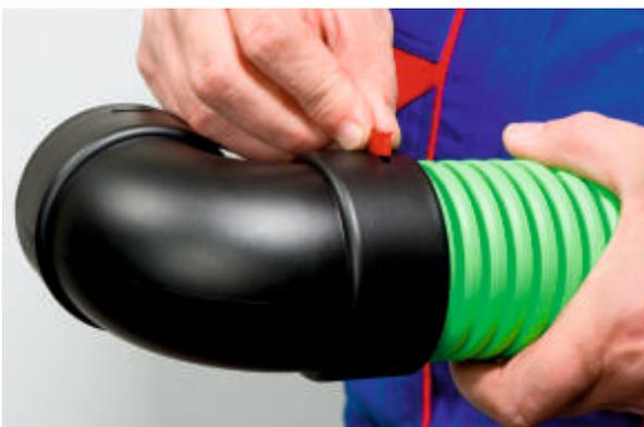
7) Löcher für die Klemmen werden über eine Rille im Rohr positioniert und beide Klemmen werden möglichst tief eingedrückt.
