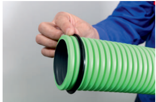
2) In die 2. oder 3. Rille wird ein Dichtungsring eingesetzt.
